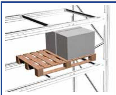
Välipalkkeja käytetään, kun lavoja käsitellään pitkältä sivulta.
