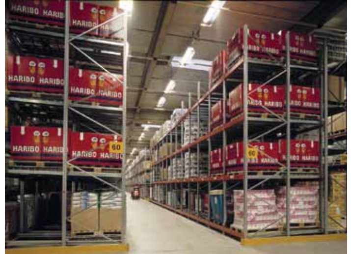
Push-back -hyllystö on kompakti syväpinontarckaisu, jossa lavat ovat helposti keräiltävissä.
