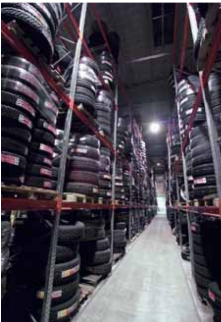
K90-kuormalavahyllyn alimmilla tasoilla kevyet läpivirtausradat tehostavat keräilyä.
