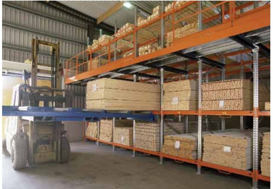
KASTEN K90-kuormalavahylly puutavarannippujen säilytykseen ja myyntiin. Lastauskelkka helpottaa raskaiden puutavarannippujen käsittelyä.
