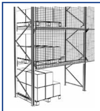
Suojaverkot estävät tavaroiden putoamisen ja tarvittaessa pääsyn johonkin varaston osaan.
